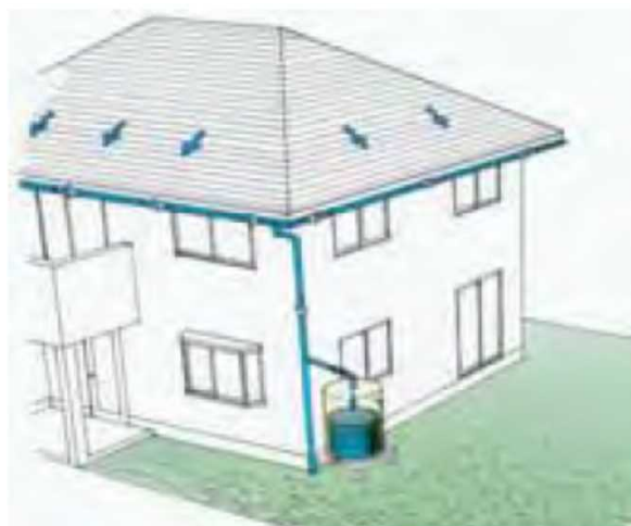
各戸貯留施設の例(地上タイプ)
